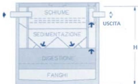
FOSSA SETTICA IMHOFF per la sedimentazione e digestione degli scarichi civili a norma UNI EN 12566-3:2016
